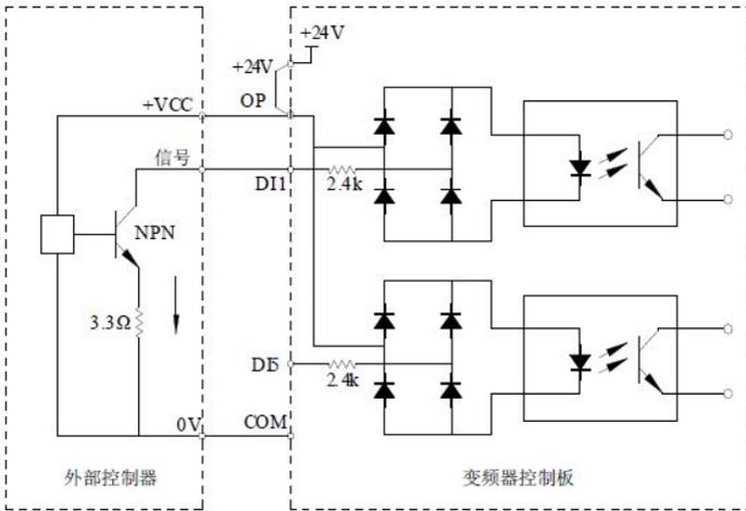
图 3-7 漏型接线方式
