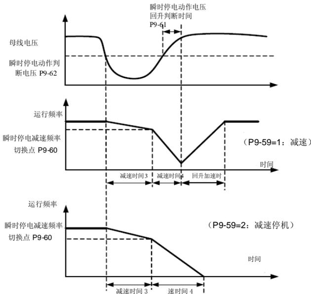
图 6-25 瞬时停电动作示意图
