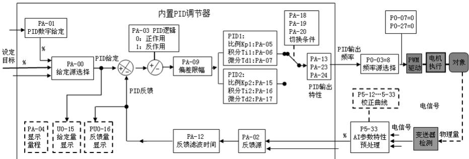
图 4-22 过程控制的频率闭环控制
