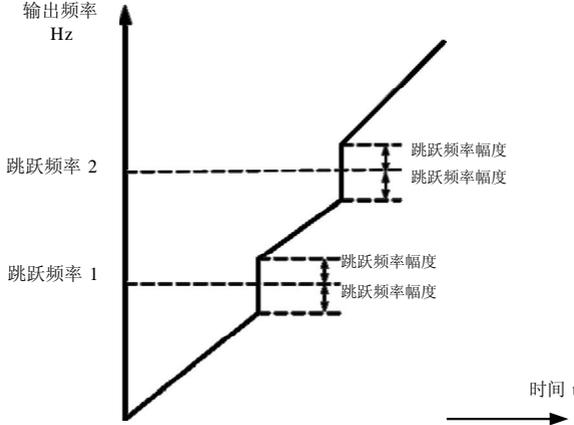
图 6-18 加减速过程中跳跃频率有效示意图
