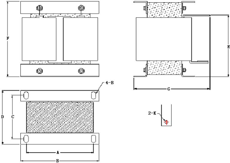
图 2-8 外置电抗器尺寸示意图
