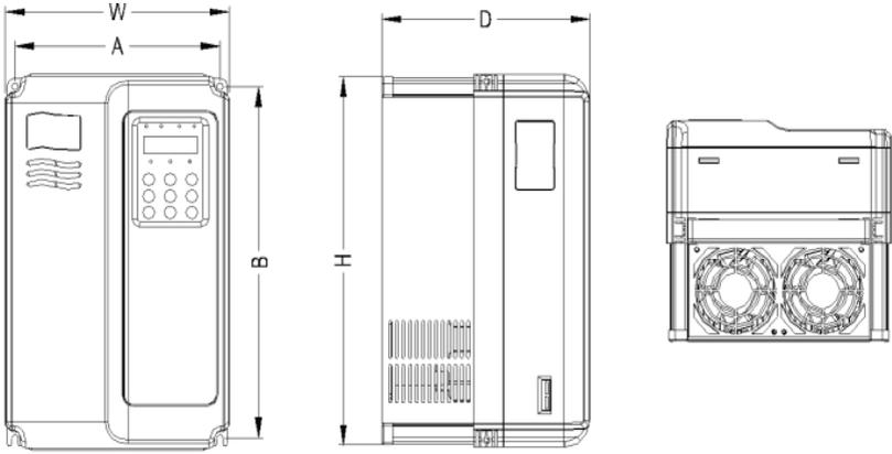
图 2-4 PC6000 系列 塑胶结构外型尺寸及安装尺寸示意图
