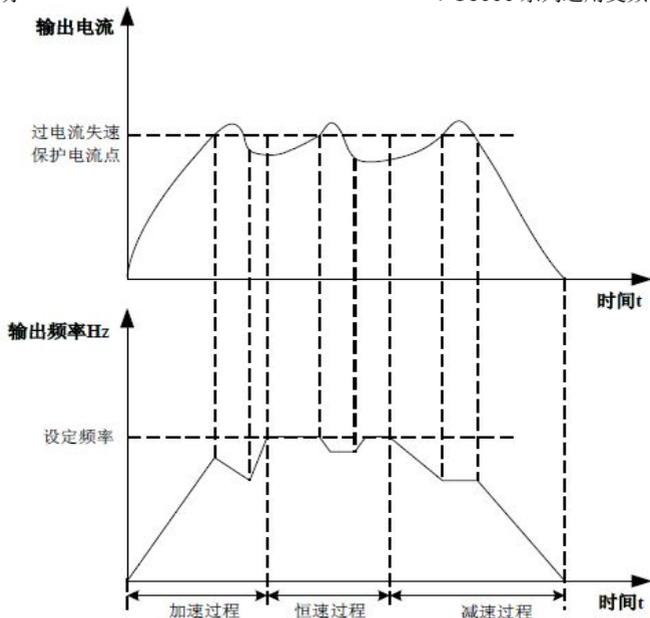
图 6-24 过流失速保护示意图
