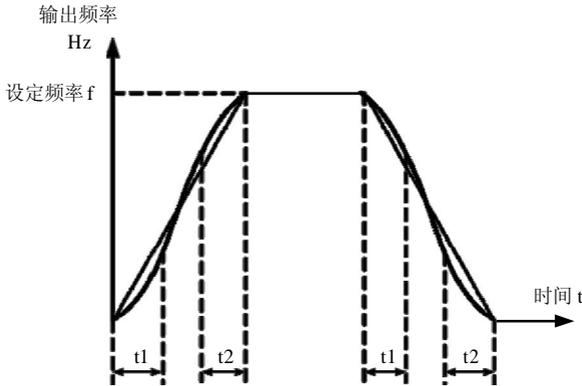
图 6-11 S 曲线加减速 A 示意图
