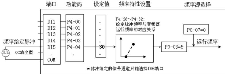
图 4-21 脉冲给定频率功能码设置
