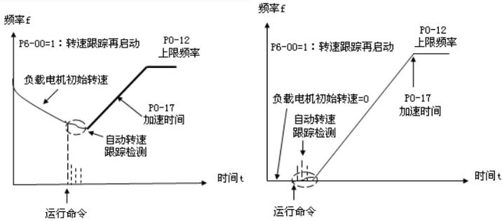
图 4-9 速度跟踪再启动方式
