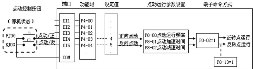
图 4-15 通讯 DI 端口点动运行
