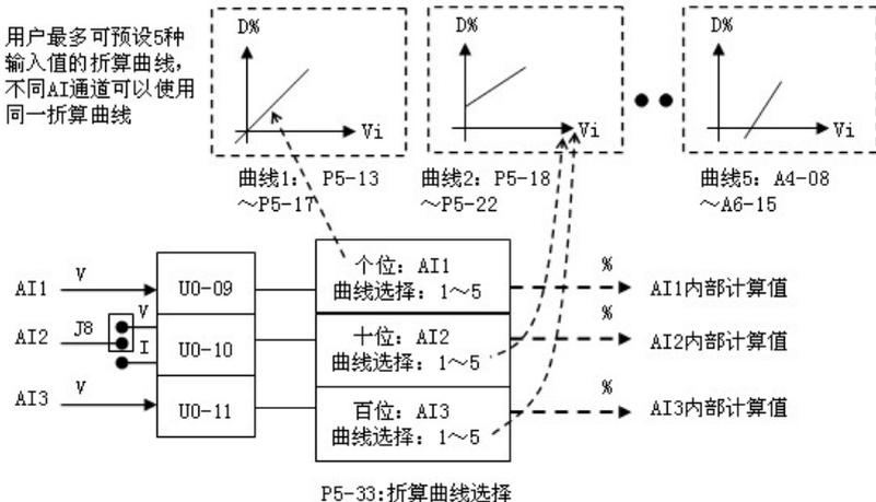
图 4-30 AI 信号对应实际给定
