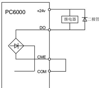
图 3-10 数字输出端子接线示意图
