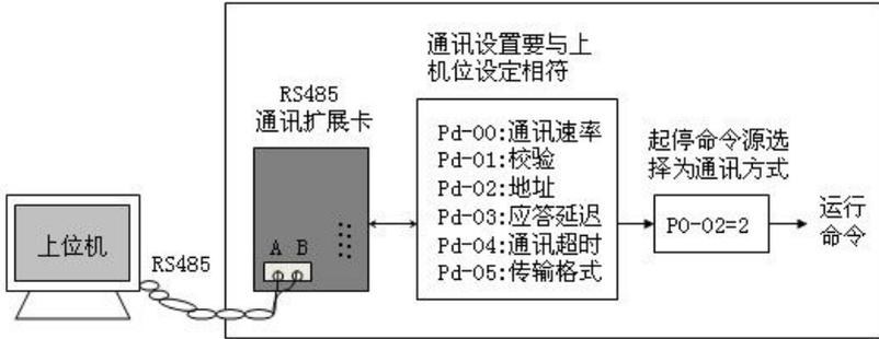
图 4-7 通讯启停控制方式举例
