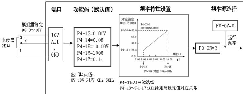
图 4-19 AI1 电压型输入给定频率功能码设置
