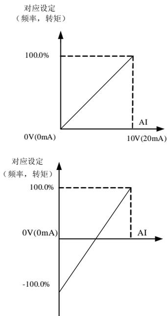
图 6-10 模拟给定与设定量的对应关系
