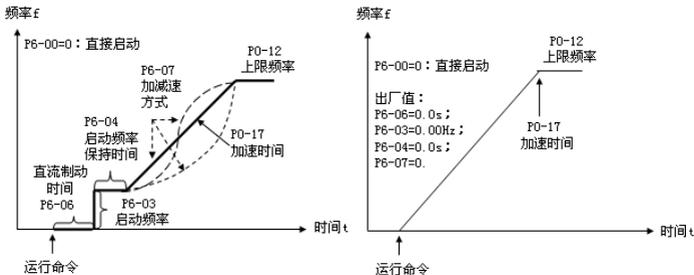
图 4-8 直接启动方式
