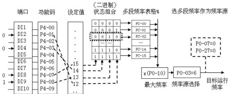
图 4-24 多段速模式的设置
