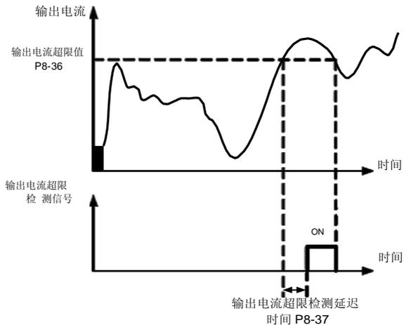
图 6-22 输出电流超限检测示意图
