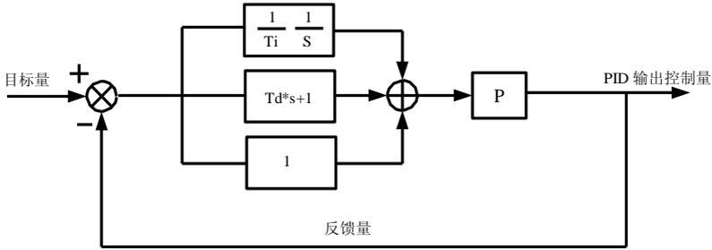
图 6-26 过程 PID 原理框图
