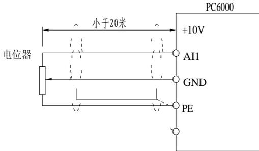
图 3-5 模拟量输入端子接线示意图
