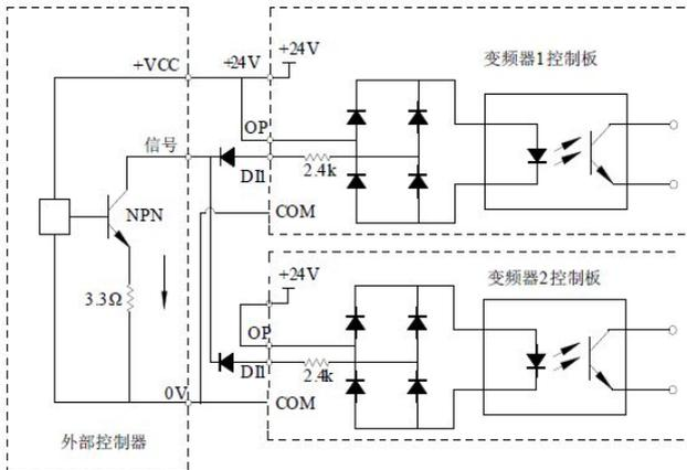
图 3-8 多台变频器DI端子并接漏型接线方式
