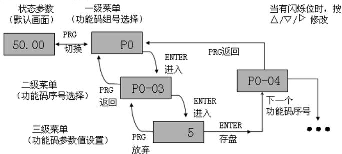
图 4-2 三级菜单操作流程图
