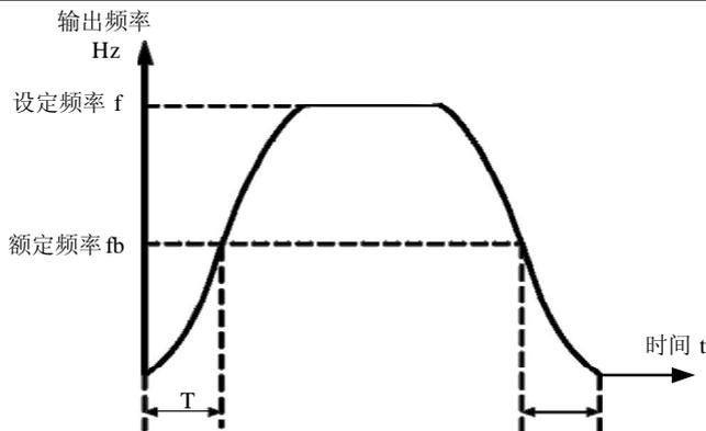
图 6-12 S 曲线加减速 B 示意图
