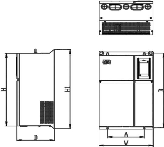
图 2-5 PC6000 系列 钣金结构外型尺寸及安装尺寸示意图
