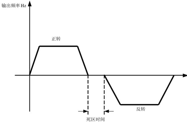
图 6-15 正反转死区时间示意图
