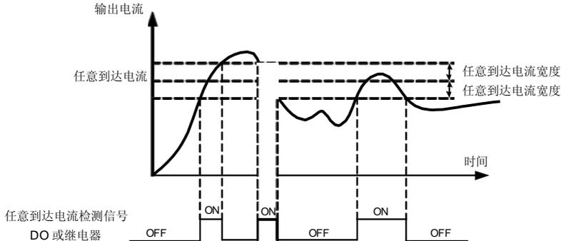
图 6-23 任意到达电流检测示意图
