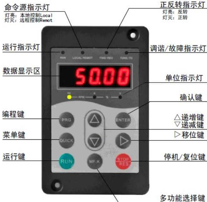
图 4-1 操作面板示意图
