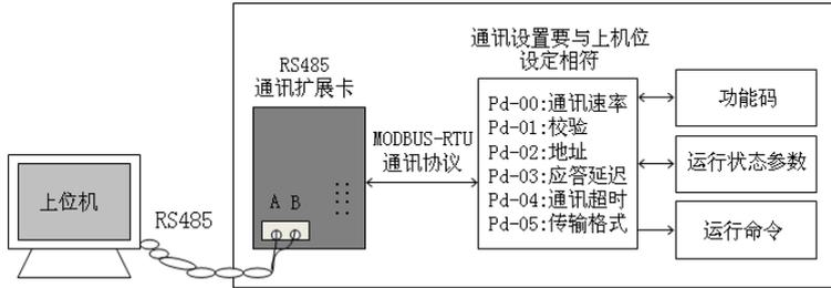
图 4-31 变频器串行通讯的使用
