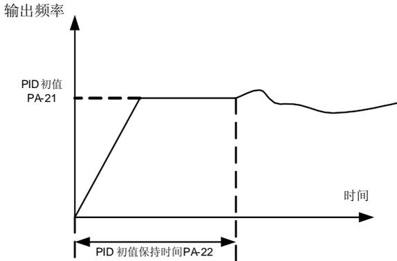
图 6-28 PID 初值功能示意图
