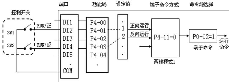
图 4-5 端子启停控制方式举例
