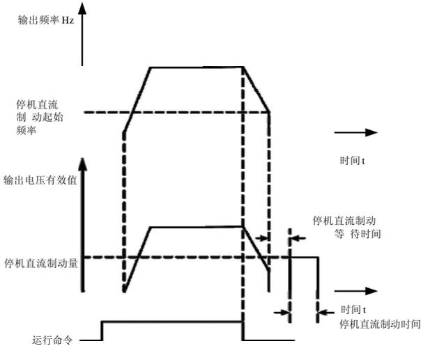
图 6-13 停机直流制动示意图
