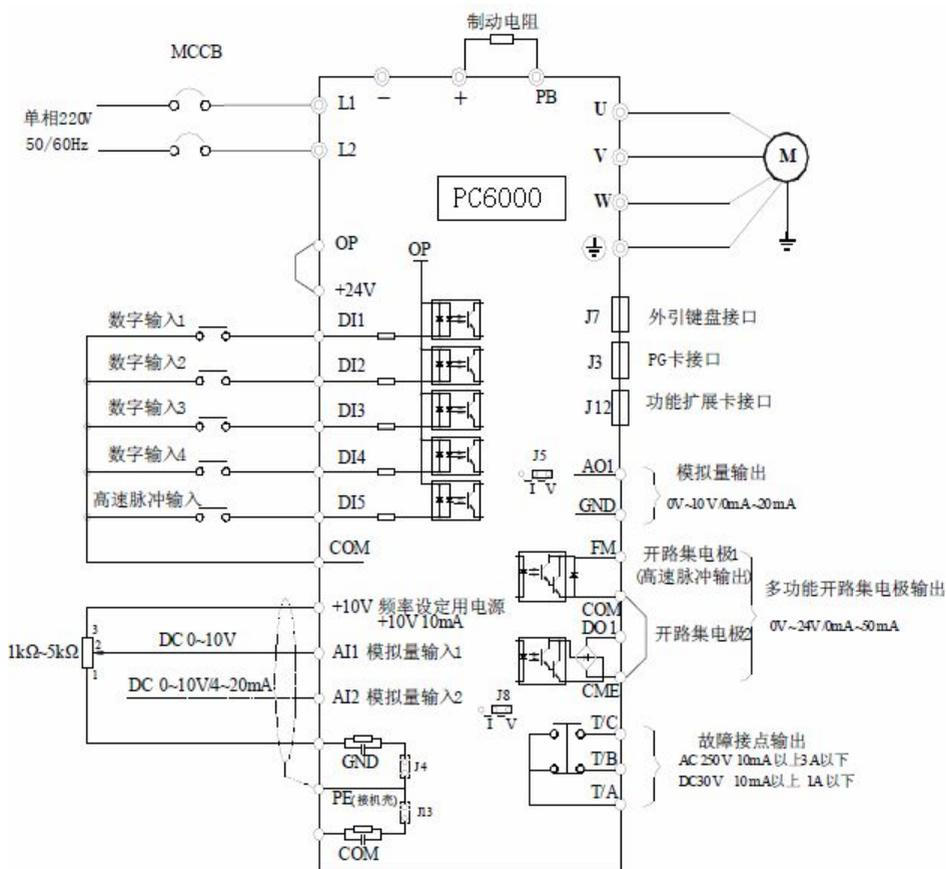
图 3-3 变频器控制回路接线方式
