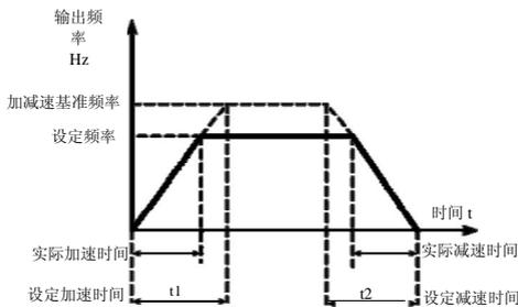
图 6-1 加减速时间示意图
