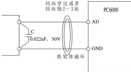
图 3-6 模拟量输入端子处理接线图
