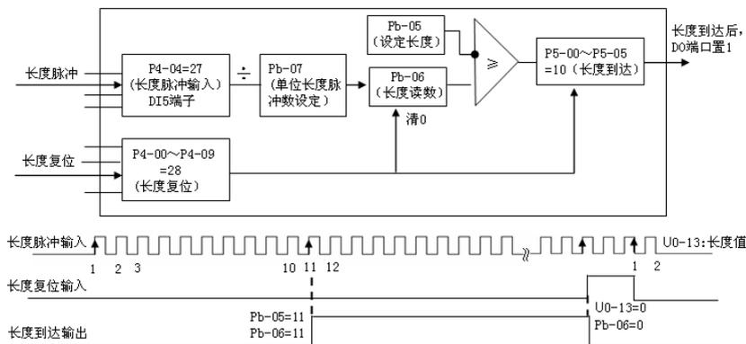
图 4-26 定长控制模式功能码设置
