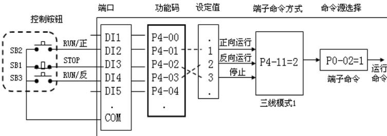
图 4-6 端子启停控制方式举例
