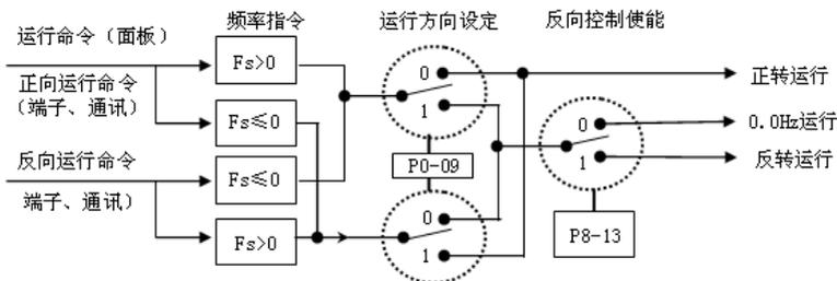
图 4-25 电机运转方向设置
