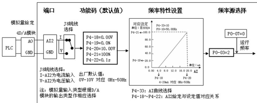
图 4-20 AI2 电流型输入给定频率功能码设置
