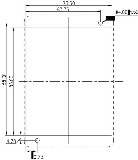
图 2-7 外引键盘的安装开孔尺寸
