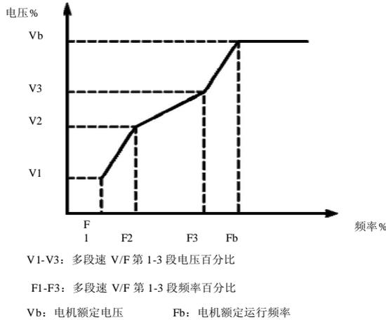
图 6-4 多点 V/F 曲线设定示意图
