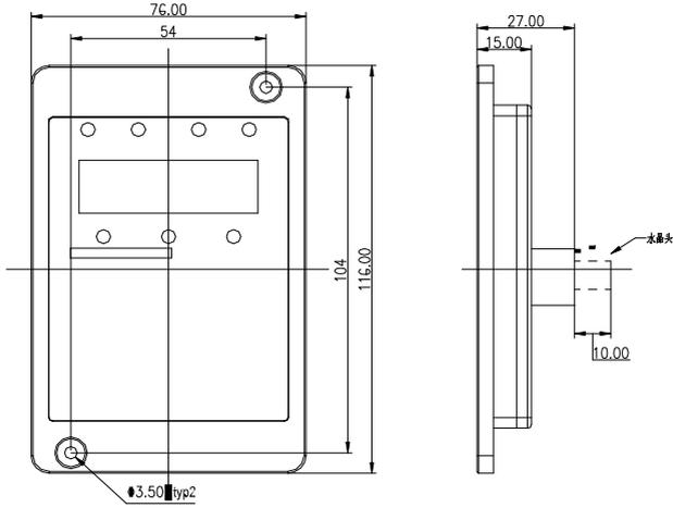
图 2-6 外引键盘的外型尺寸
